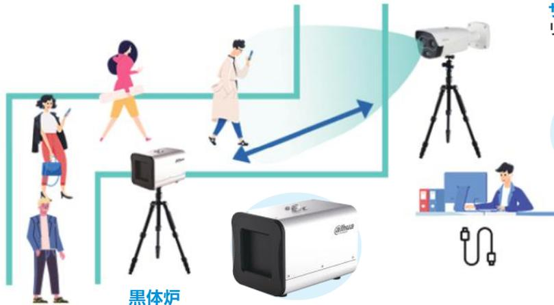
**黒体炉**温度基準源でサーマルカメラの視野範囲に
