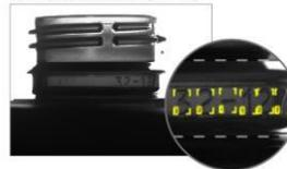
電子部品のレーザーエッチングコードの読取
